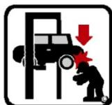
При остановке кареток подъёмника на относительно небольшой высоте существует риск удара о выступающие части.
