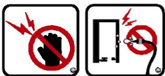
Избегайте использования воды, пара и растворителей, пневматической окраски в зоне работы подъемника, где расположены электрические кабели, в частности, вблизи электрогидравлического агрегата.
