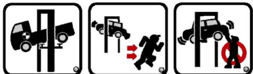
Падение транспортного средства с подъёмника может произойти по причине его неправильной установки на платформах, если оно по размеру не соответствует подъёмнику, а также в случае чрезмерного движения транспортного средства. В этом случае необходимо немедленно покинуть рабочую зону.
