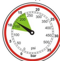
Показания манометров при нормальных условиях
