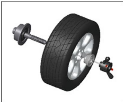
Хвостовик вала → колесо (установочная поверхность диска обращена внутрь) → конус (сужением внутрь) → быстросъемная гайка.
