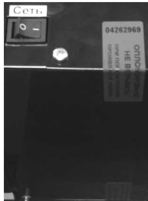
Рис.4. Пломбировка корпуса блока управления
