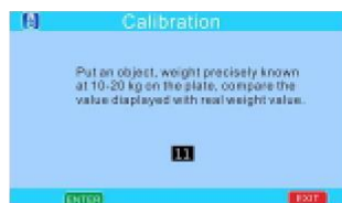
Программа предлагает установить на весы предмет весом 11-15 кг, затем изменить значение на дисплее
