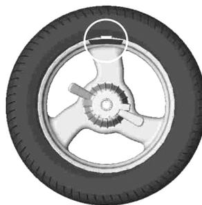
Рисунок 6.5 – Груз установлен в «12 часов»
