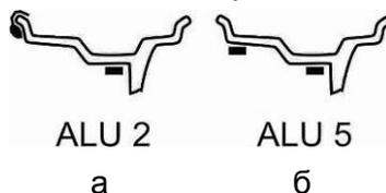
Рисунок 7.3 – Допустимые схемы установки грузов для режима Split
