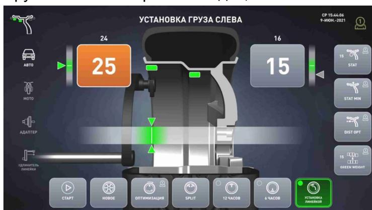
Рисунок 5.10 – Экран при установке груза линейкой
