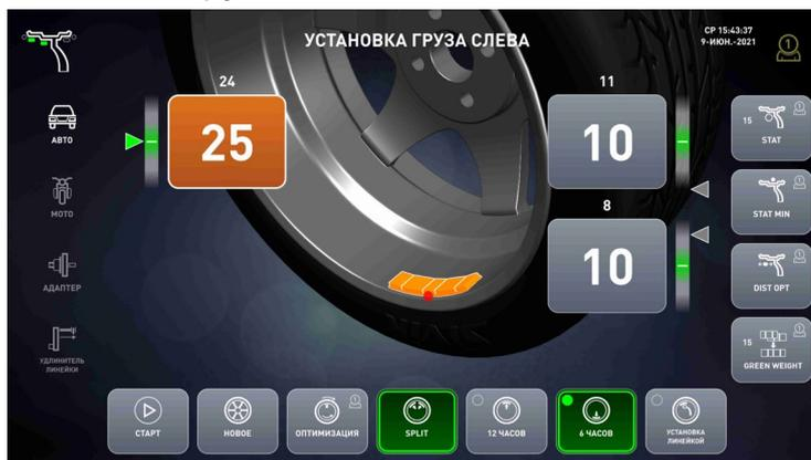
Рисунок 7.5 – Экран установки грузов в режиме Split
