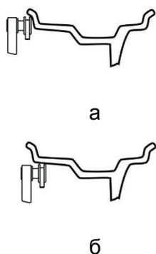
Рисунок 5.2 – Подвод линейки при первом измерении
