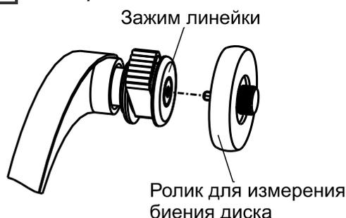
Рисунок 7.7 – Ролик для измерения биений
