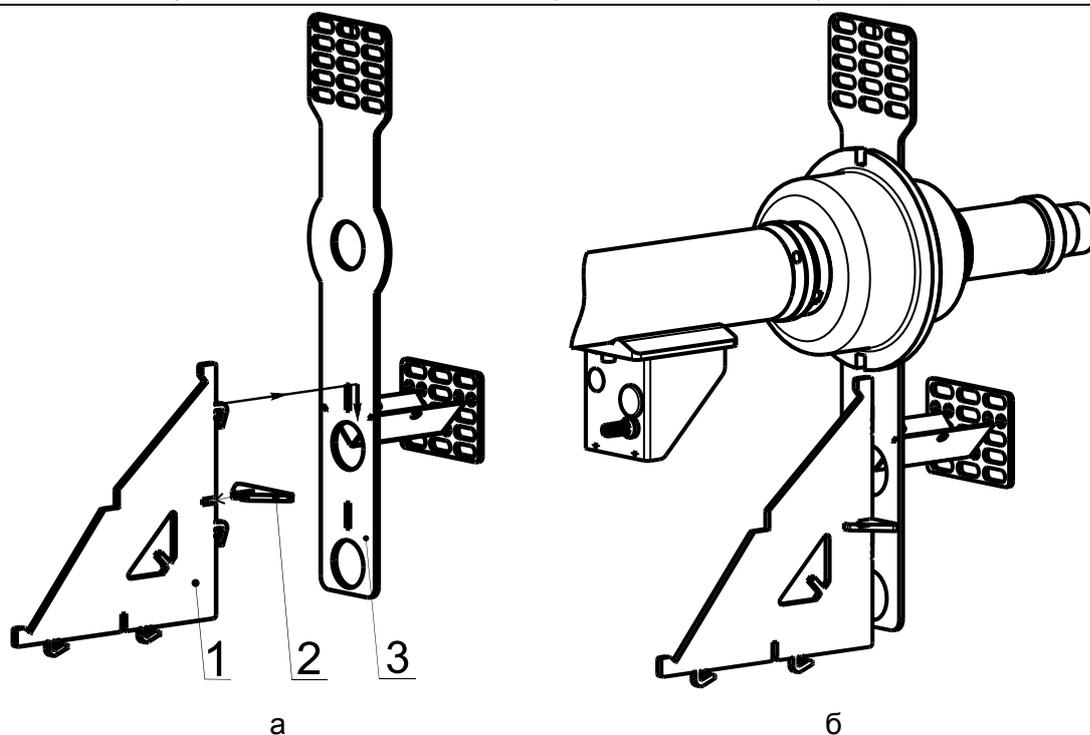
Рисунок 8.8 – Сборка и установка калибра лазерного указателя
