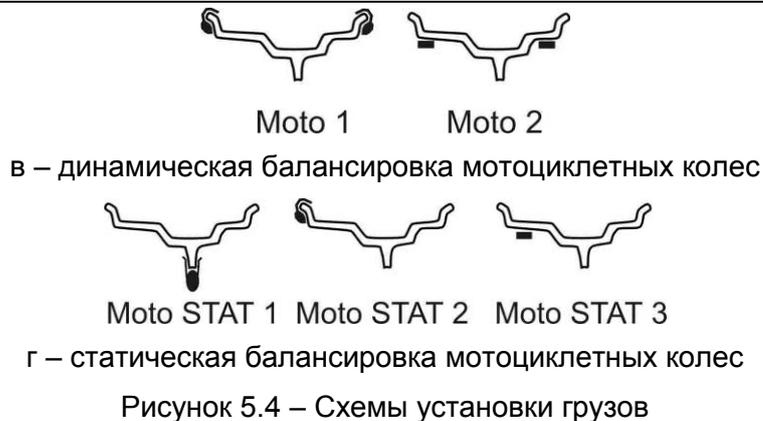
После ввода размеров на экране автоматически будут показаны возможные схемы установки грузов. Текущая схема будет выделена цветом и яркой зеленой точкой, рисунок 5.5. Если схема определена правильно, то можно сразу выполнять измерение дисбаланса.
