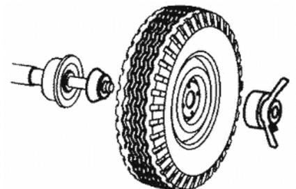
Рисунок 6.8 – Установка колеса
