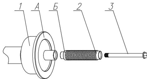
1 – шпиндель станка; 2 – вал; 3 – болт
