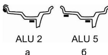
Рисунок 7.1 – Допустимые схемы установки грузов для режима GreenWeight
