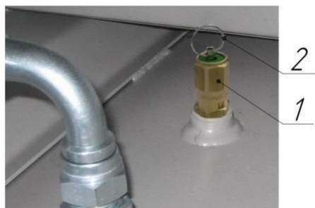
Рисунок 11 – Клапан предохранительный пружинного типа
