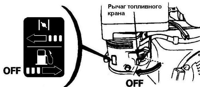
Рисунок 12 – Рычаг топливного крана в положении "OFF" ("Выключено")
