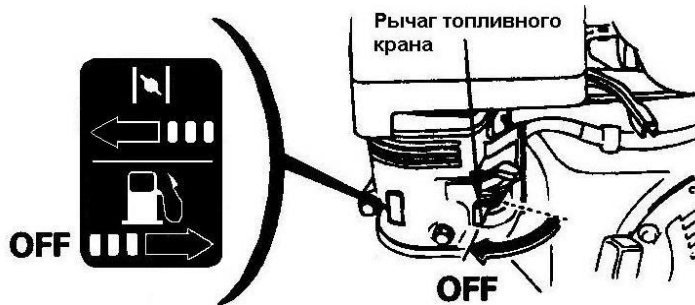
Рисунок 12 – Рычаг топливного крана в положении "OFF" ("Выключено")
