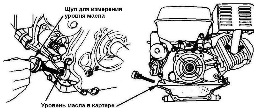
Рисунок 2 – Уровень масла в картере двигателя
