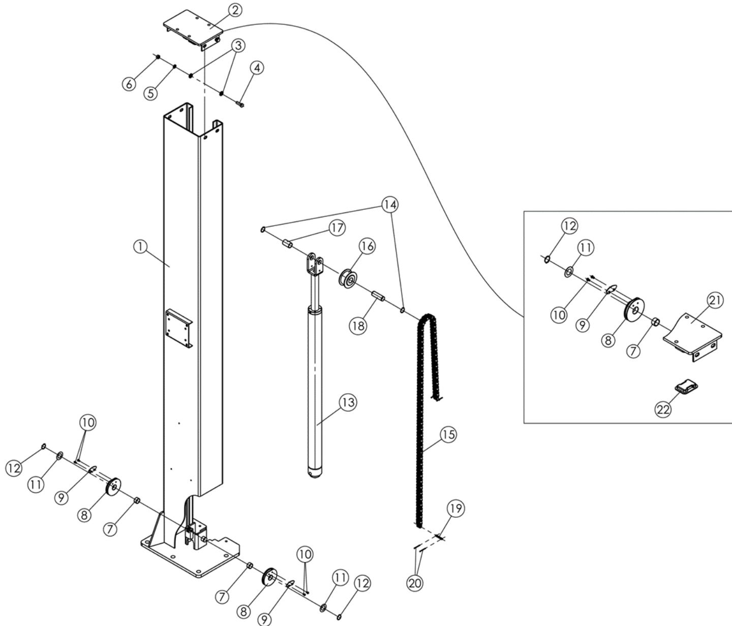
**ДЕТАЛИ СБОРОЧНОГО ЧЕРТЕЖА ОСНОВНОЙ СТОЙКИ**
