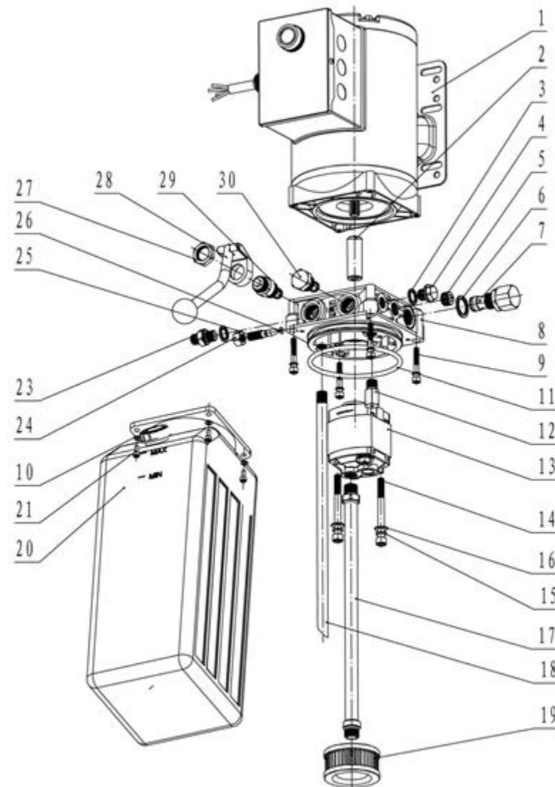
**ДЕТАЛИ СБОРОЧНОГО ЧЕРТЕЖА НАСОСНОЙ СТАНЦИИ**
