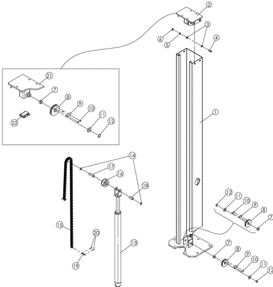
**ДЕТАЛИ СБОРОЧНОГО ЧЕРТЕЖА ВТОРОСТЕПЕННОЙ СТОЙКИ**
