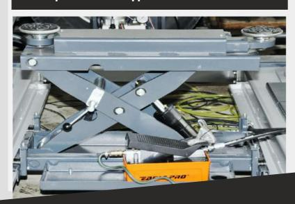
ДЛЯ РЕГУЛИРОВКИ РАЗВАЛ/СХОЖДЕНИЯ НА 3D СТЕНДЕ
