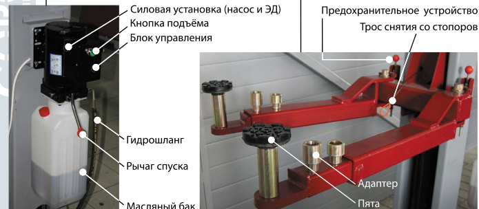
Рисунок 3 - Общее устройство изделия
