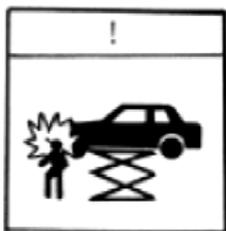
При остановке подъемника на относительно небольшой высоте для работы существует опасность удара о выступающие части.
