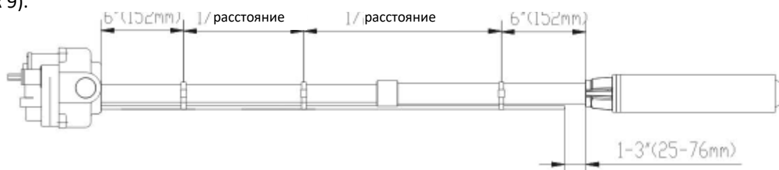
Рисунок 9: Крепление трубопровода обратной линии к насосу
