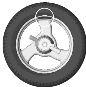
Рисунок 6.6 - Груз установлен в «12 часов»
