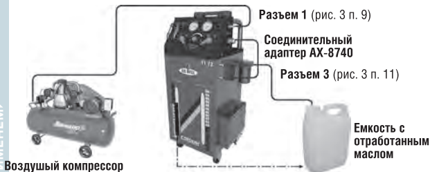
Рисунок 6 – Схема процесса слива отработанного масла из стенда
