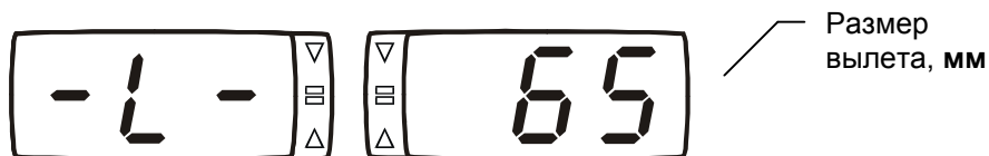
Рисунок 2.21 – Показания индикаторов во время пользования электронной линейкой для измерения вылета (измеритель диаметра выключен)
